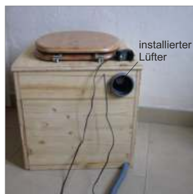
Ansicht der Rückseite, mit Anschluss Entlüftungsrohr, Urinschlauch, und Netzteil
